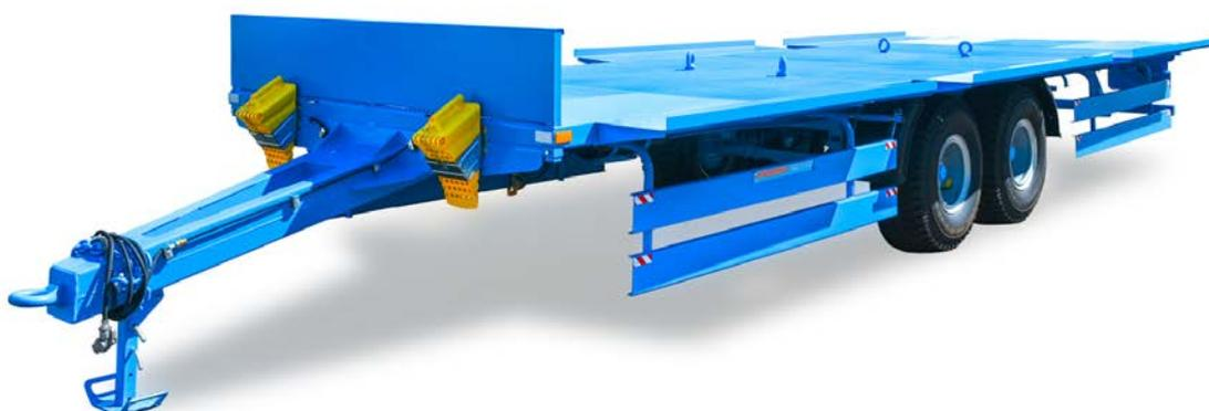
Полуприцеп-платформа универсальный ППУ-9 предназначен для транспортировки различных грузов, в т.ч. ящиков с овощами и фруктами, длинномерных материалов, рулонов и тюков сена, соломы, льна, сформированных пресс-подборщиками, по всем типам дорог и в полевых условиях.
