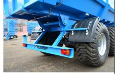
**Широкопрофильные шины** уменьшают давление на почву и улучшают проходимость давление в шинах - всего 0,4 МПа
