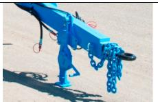
Регулируемая опора хранения (домкрат)облегчает зацепление полуприцепа за трактор, может отсоединяться от дышла и использоваться при ремонте полуприцепа.
