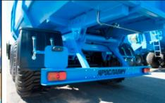
Задний бампер со световым оборудованием
